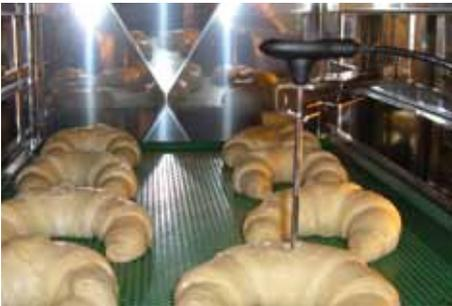
Pour les croissants à pousser placer la sonde à cœur verticalement. Utiliser le positionneur.
